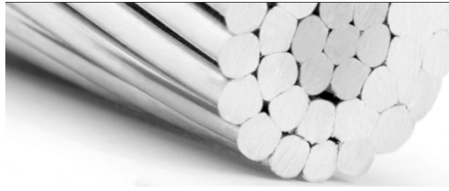
Fig. 59 El porcentaje real de huecos en los cables es menor porque los hilos se aplastan unos contra otros durante el proceso de fabricación.
