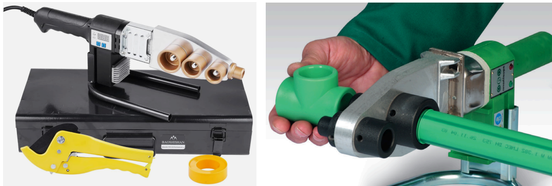
Fig. 53 Unión entre tubería y accesorio de PPR usando la herramienta apropiada.
