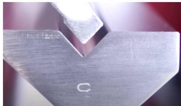
Fig. 27 Detalle de matriz (inferior) y punzón (superior) de una plegadora
