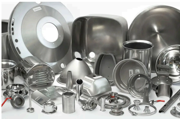
Fig. 28 Piezas fabricadas por embutición profunda de chapa de acero inoxidable.
