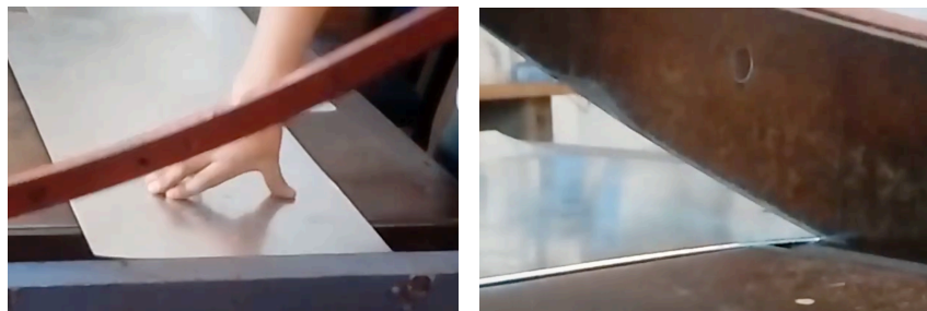
Fig. 30 Cizallado manual de una lámina metálica.
