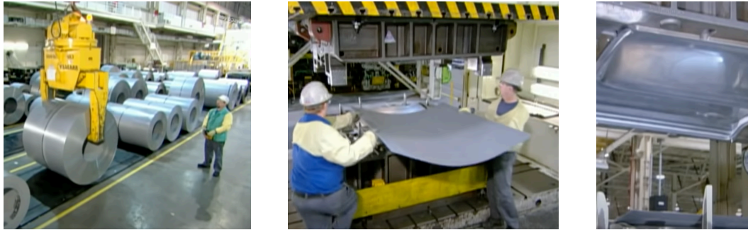
Fig. 23 A partir de una bobina de chapa se fabrica una puerta de coche por estampación.
