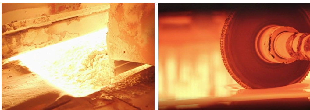
Fig. 16 Vertido y cortado del vidrio fundido [GUARDIANGLASS].
