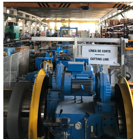
Fig. 56 Máquina de corte automático de chapa ferromagnética. [GED]
