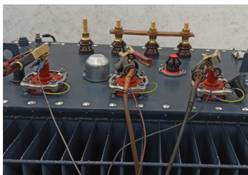
Fig. 105 Transformador 400 kVA durante un ensayo de cortocircuito y medidas del vatímetro. [GED]
