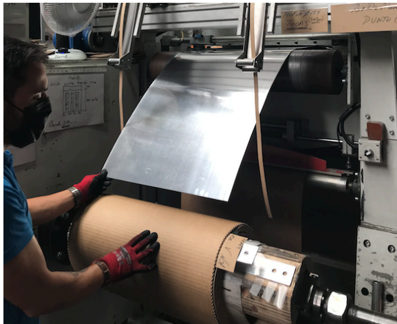
Fig. 63 El operario comienza a enrollar banda conductora para la bobina de BT. [GED]
