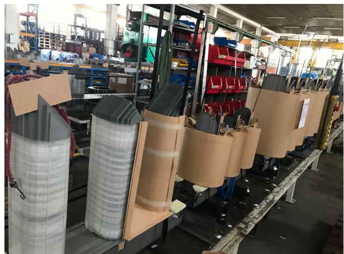
Fig. 68 Línea de montaje para ensamblado y conexionado de la parte activa. [GED]
