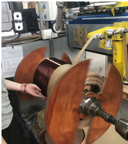
Fig. 65 Bobinando las capas del devanado AT. [GED]
