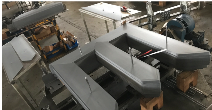
Fig. 59 Núcleo en proceso de apilamiento. [GED]
