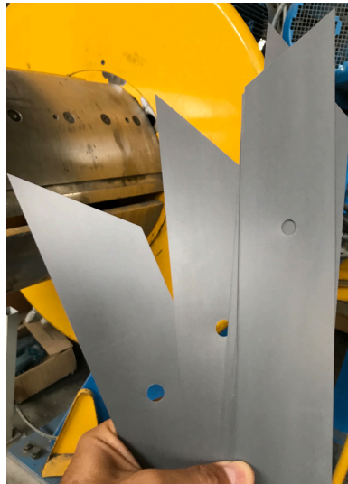
Fig. 57 Chapas ya cortadas y punzonadas para un transformador de 50 kVA. [GED]
