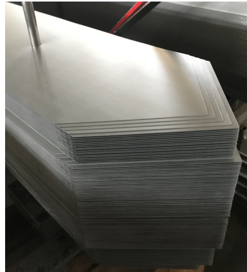
Fig. 58 Detalle del escalonamiento producido por la diferente longitud de cada chapa. [GED]
