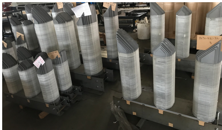
Fig. 60 Núcleos ya montados sobre la viga base con sus refuerzos de acero (culata). [GED]
