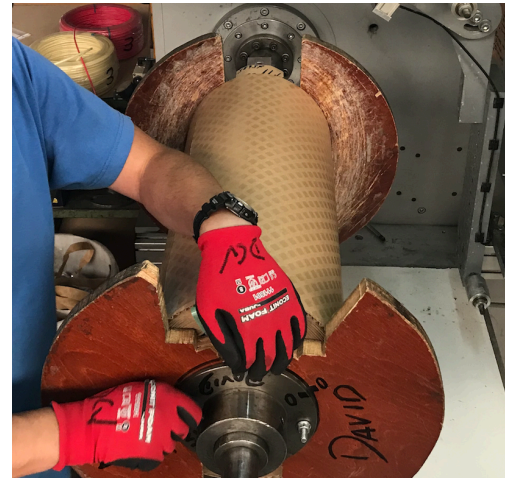
Fig. 64 Después se pasa a bobinar encima las capas de la bobina AT. [GED]
