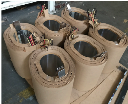
Fig. 69 Bobinas endurecidas y secas, listas para insertarlas en los núcleos prefabricados. [GED]
