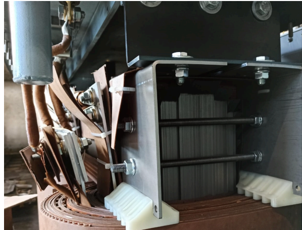
Fig. 86 Detalle de espaciadores entre yugo y bobinas, refuerzos del yugo y salida de cables al cambiador de tomas. [GED]
