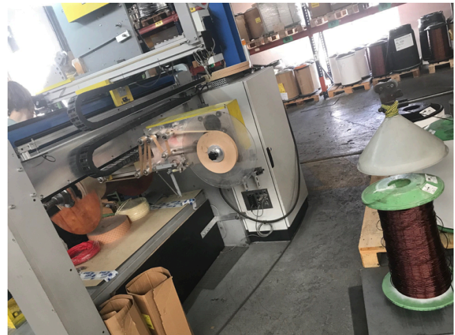
Fig. 66 Parte trasera de la bobinadora AT y carrete de hilo (abajo derecha). [GED]
