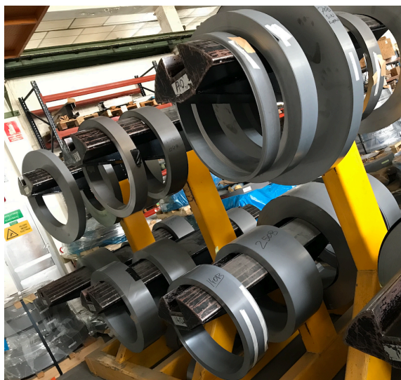
Fig. 55 Bobinas de chapa magnética sin cortar de distintos anchos. [GED]
